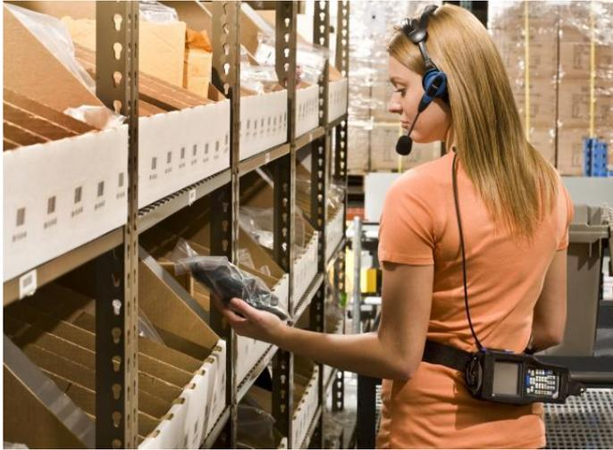
Технология представляет собой беспроводной компьютер, который «общается» с WMS-системой (например на «1С:Предприятии») при помощи радиосвязи, и гарнитуру, посредством которой оператор слышит задания и может сообщать об их выполнении. Voice Picking уже работает на складах компаний «Метро Груп Логистикс», г. Ногинск и ООО «Веста-Фудс», г. Ростов-на-Дону и др.
